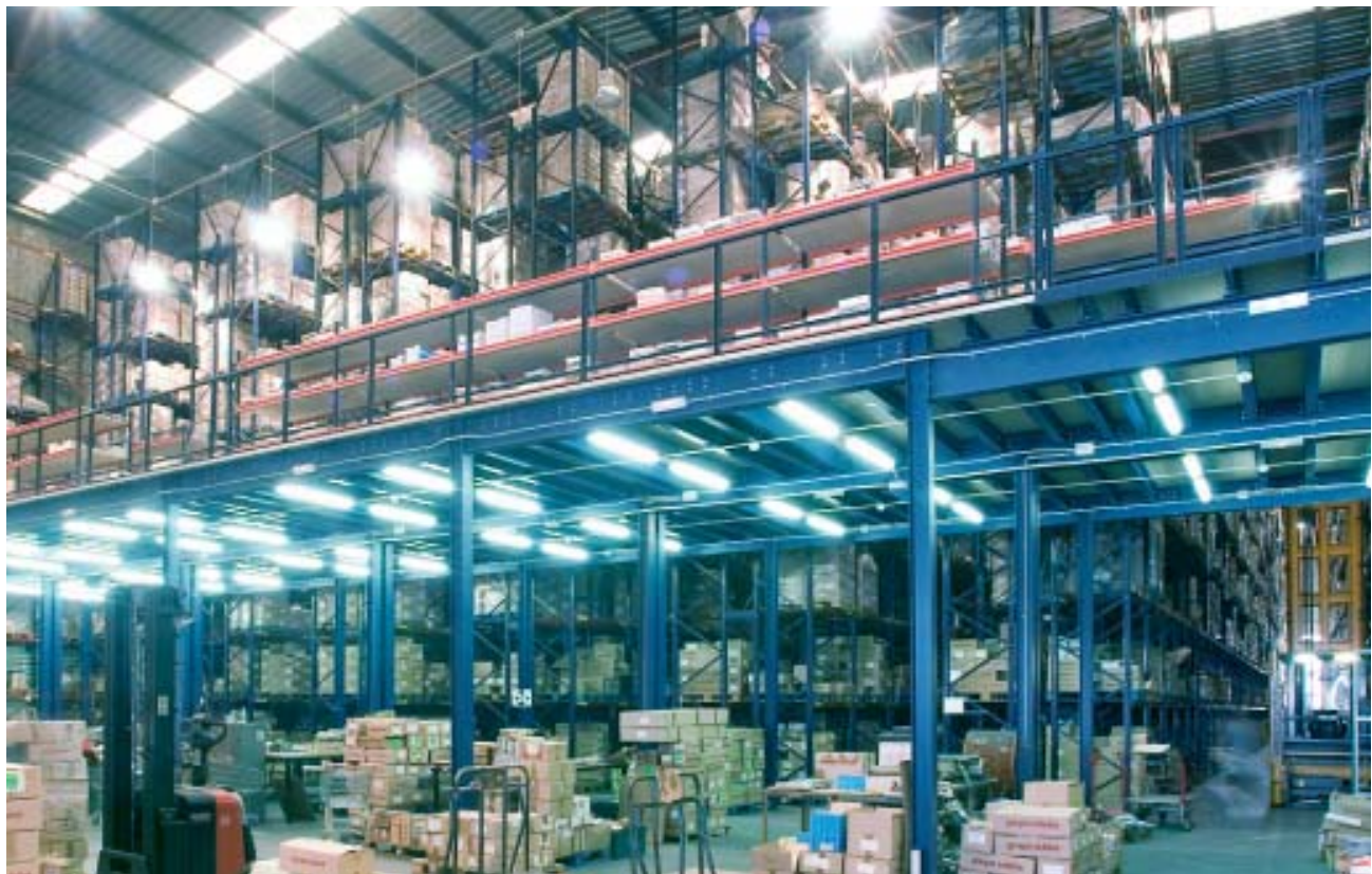
En la parte inferior de la entreplanta se almacena producto voluminoso y en la superior se han colocado estanterías para guardar mercancía de tamaño pequeño y mediano.
